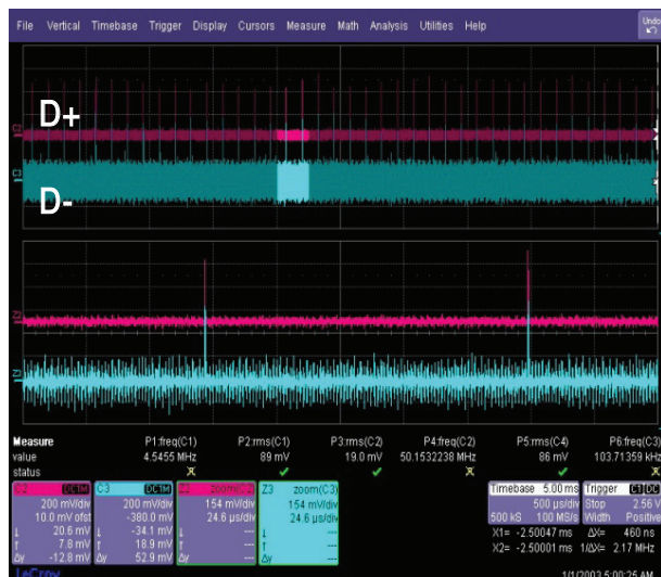
USB D-/D+ (CN502 clavija1, 2 y clavija7, 8) < Forma de onda de la señal USB D± >
