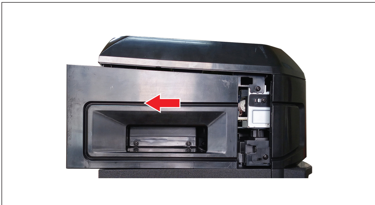
Figura 3. Desmontaje del lateral Izq/Dcho del panel - 3
