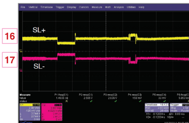
Fig 4-2. SL- & SL+ para el motor de giro(SPINDLE) (IC400 Pin11, 12)
