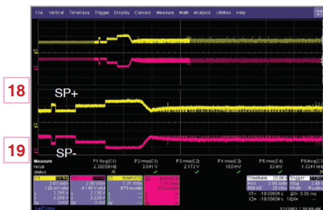
Fig 4-3. SP- & SP+ para el motor de giro(SPINDLE) (IC400 Pin17, 18)
