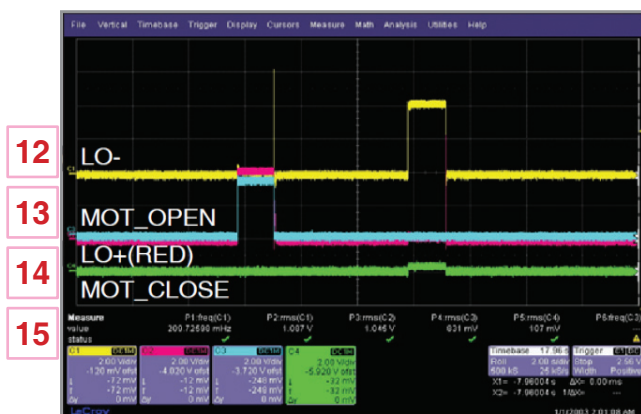
Fig 4-1. LO- & LO+ / MOT_OPEN & MOT_CLOSE para el motor de la bandeja (IC400 Pin6, 7, 9, 10)
